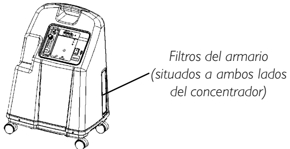
FIGURA 9 - UBICACIÓN DE LOS FILTROS EN EL ARMARIO
